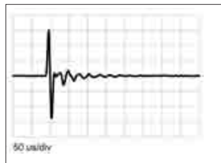
Bild 2: Impulsverhalten des MKH 800/ MKH 800 TWIN
