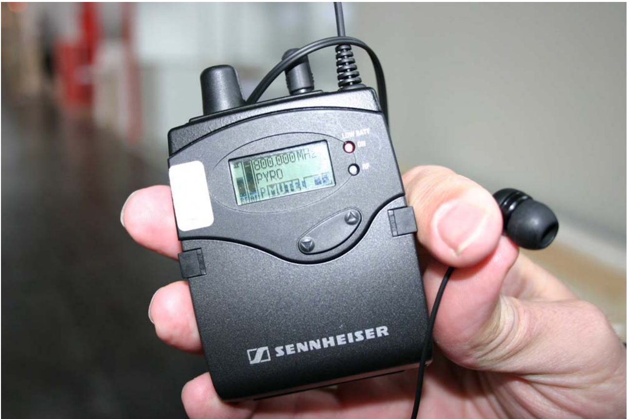
Abbildung 4 - EK 2000 IEM mit demoduliertem LTE-Trägersignal
